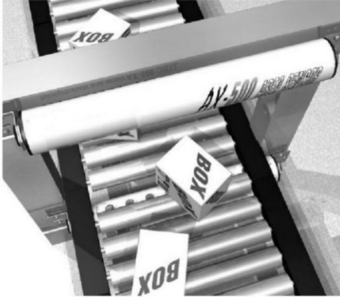
Movimentazione: rilevazione di presenza e posizione di oggetti su nastro trasportatore
